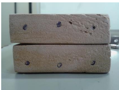
Figura 1: Marcação dos pontos para fixação da dobradiça.
