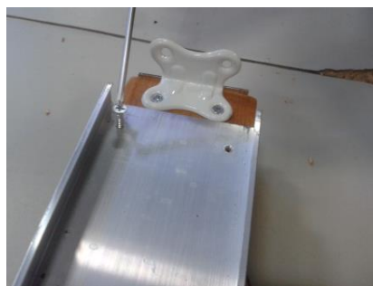
Figura 2: Fixação da canaleta e da cantoneira.
