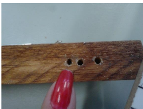
Figura 9: Ilustração da sequência de furos feitos na lateral da ripa que serve de base para a calha.
