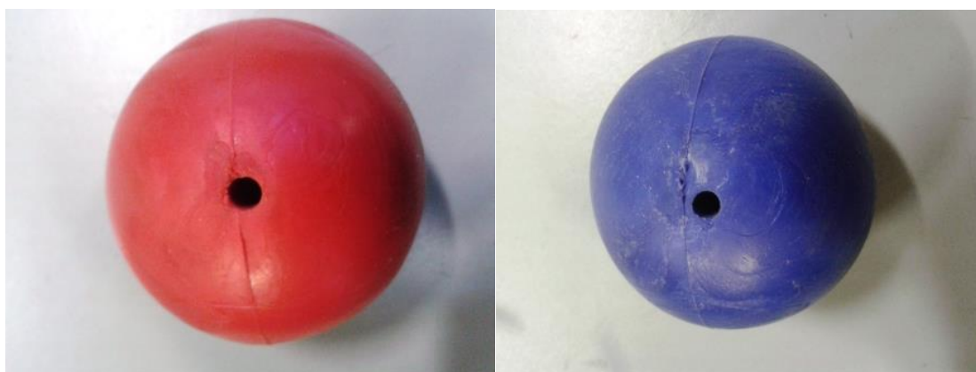
Figura 1: Ilustração do orifício que deve ser feito em cada bolinha.
