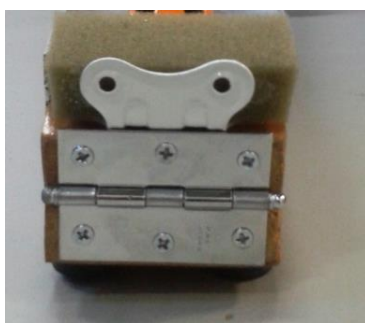
Figura 5: Fixação da espuma na cantoneira.
